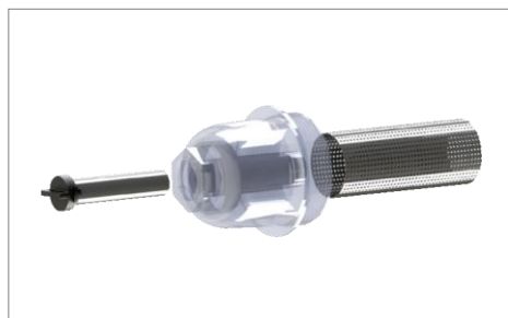
Rimozione del magnete (ruotare di 90° in senso orario). Lavare con acqua e sciacquare a fondo sotto il rubinetto in modo da rimuovere completamente le impurità e i detriti.
