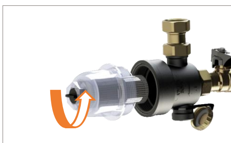
Svitare in verso antiorario direttamente il tappo portamagnete aiutandosi con una chiave da 29 mm. Assicurarsi che l'acqua venga raccolta in un contenitore di dimensioni adeguate.
