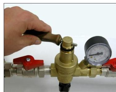
Tutti gli alimentatori Malgorani sono testati prima di essere imballati; durante il test la pressione in uscita viene regolata a 1.5 bar. La pressione in uscita può essere facilmente modificata anche una volta che l'apparecchio è installato.
